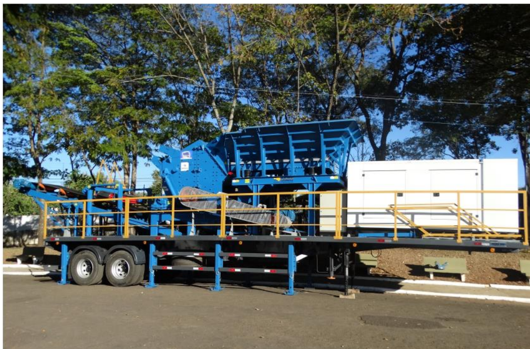
Figura 100: Usina de reciclagem de resíduos da construção civil móvel
